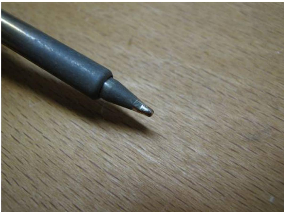
Ce tout petit apport de soudure sur la panne va permettre un bien meilleur contact thermique entre la panne et l'objet à chauffer.
