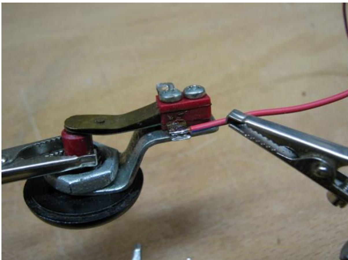
Réalisation de la soudure.
