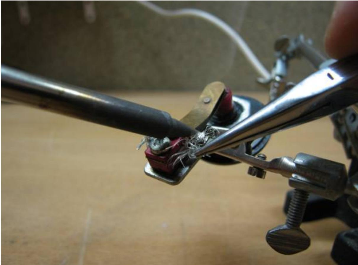
Une fois les fils retirés, j'enlève la vieille soudure avec une méthode barbare, mais très simple quand l'objet est « libre » comme ce bouton : je fonds la soudure et je secoue l'objet. C'est le même mouvement qu'un coup de marteau : l'arrêt brutal du mouvement fait tomber la soudure par terre (attention les pieds). Ce n'est pas à faire quand on travaille sur de la moquette ou sur un parquet !
